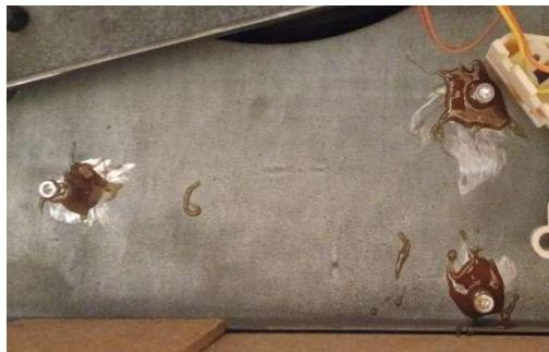
Die Stehbolzen habe ich mit Zweikomponentenkleber am Chassis angebracht. Stabilit Express hat sich hier bewährt, vorher unbedingt das Chassis den Montagestellen anschleifen um eine wirklich sichere Verklebung zu gewährleisten. Die Klebeleistung ist absolut ausreichend, selbst wenn die improvisiert erscheinen mag.
